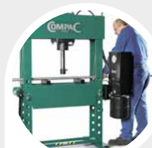
Pumpeenheden kan svinges 90 grader væk fra pressen.
