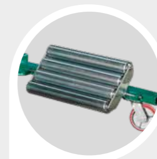
2 x 4 store ruller muliggør rotation af hjul med dybe dækmønstre.
