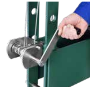
HP 30: Standard med spil til hurtig og let justering af bordhøjde.
